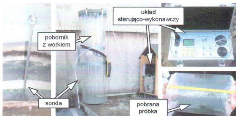
Rysunek 5. Pobieranie próbki na wlocie do biofiltra
