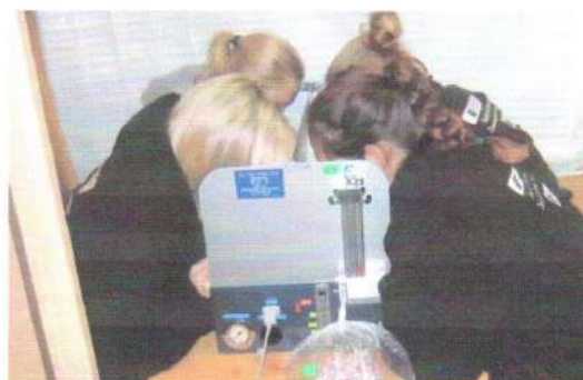
Rysunek 13. Pomiar stężenia zapachowego z użyciem TO7
