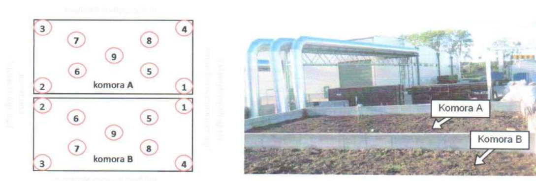
Rysunek 6. Lokalizacja punktów pomiarowych na wylocie z biofiltra
