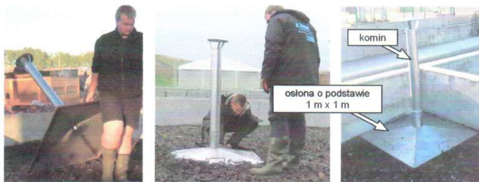
Rysunek 7. Osłona do pobierania próbek z aktywnych źródeł powierzchniowych
