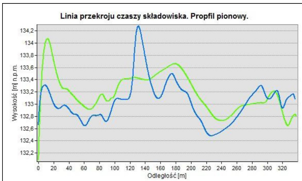
Wykres 1. Przekrój pionowy czaszy składowiska – profil nr 1.
