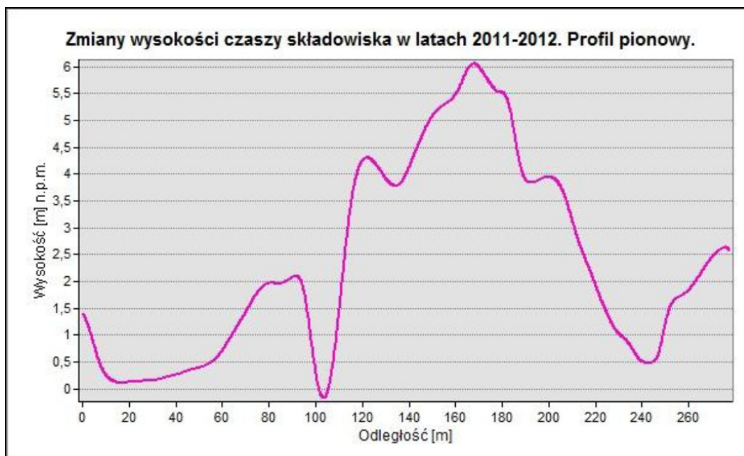
Wykres 10. Przekrój pionowy czaszy składowiska – profil nr 5.
