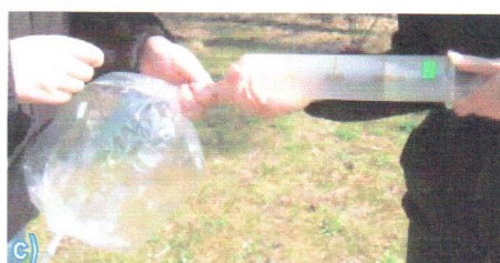
Rysunek 9. Wstępne rozcieńczanie próbki z użyciem szklanych strzykawek
